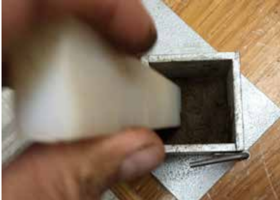
Figuras 7a y 7b. Probetas realizadas con tierra estabilizada con 6% de cal en peso seco y posteriormente compactadas por capas, han logrado subsistir su inmersión total en agua por más de 10 años. (Foto: L. Guerrero).
