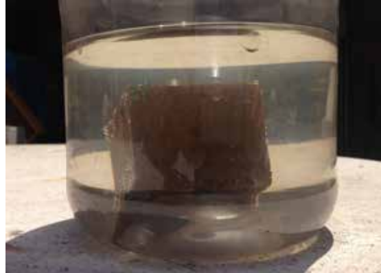
Figuras 7a y 7b. Probetas realizadas con tierra estabilizada con 6% de cal en peso seco y posteriormente compactadas por capas, han logrado subsistir su inmersión total en agua por más de 10 años. (Foto: L. Guerrero).
